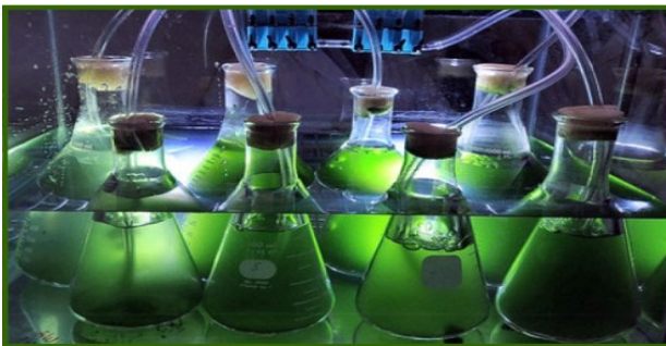
Schema ed immagine fotografica del fotobioreattore del SESLAB
